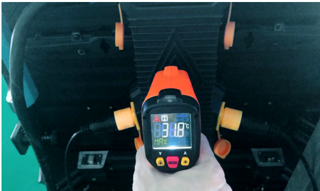
Test de temperatura de la caja de fuente de poder.
