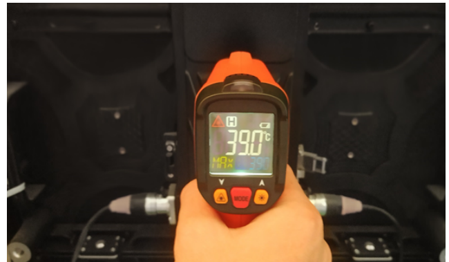
Test de temperatura de la caja de fuente de poder de las pantallas generales de la Industria.
